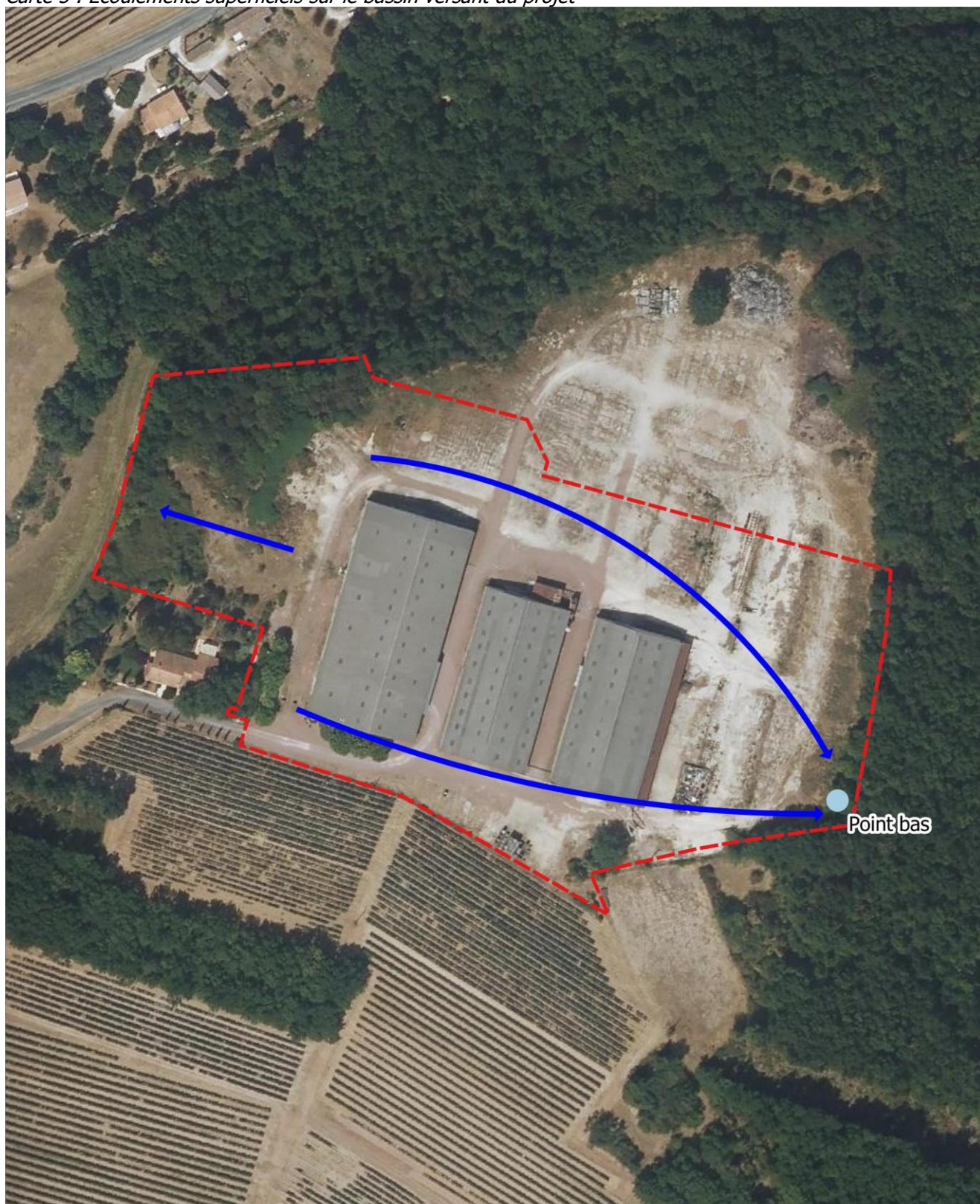
Carte 5 : Écoulements superficiels sur le bassin versant du projet
